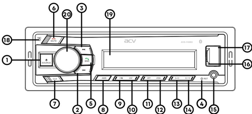
1. **Source** - кнопка включения/выключения устройства, выбора режимов ресивера.
